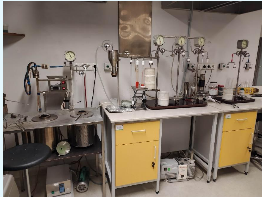
Linia do grafityzacji \text{CO}_2 w Laboratorium Zakładu Geochronologii i Badań Izotopowych Środowiska Instytutu Fizyki Politechniki Śląskiej w Gliwicach.
